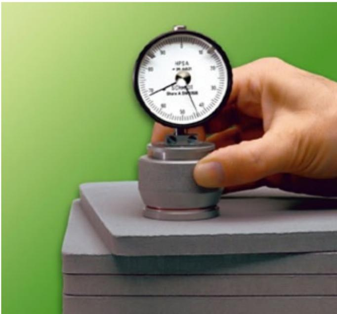
Durômetro HPSA-M com ponteiro de memória
